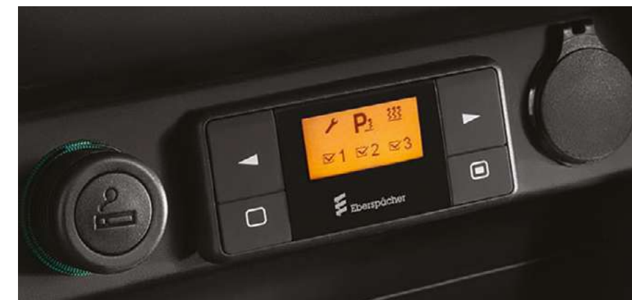
Предпусковой подогреватель с возможностью программирования
