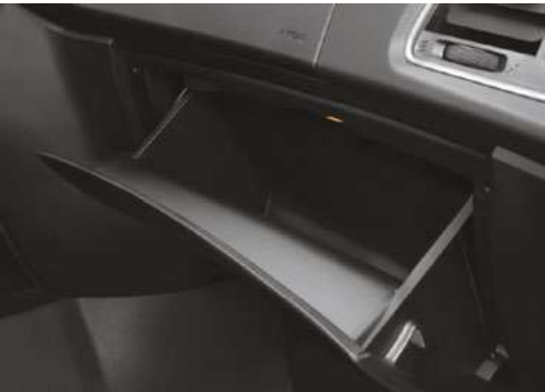
Охлаждаемый перчаточный ящик с разъемом USB
