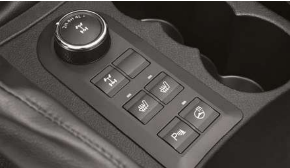
Блок управления режимами трансмиссии на центральном тоннеле
