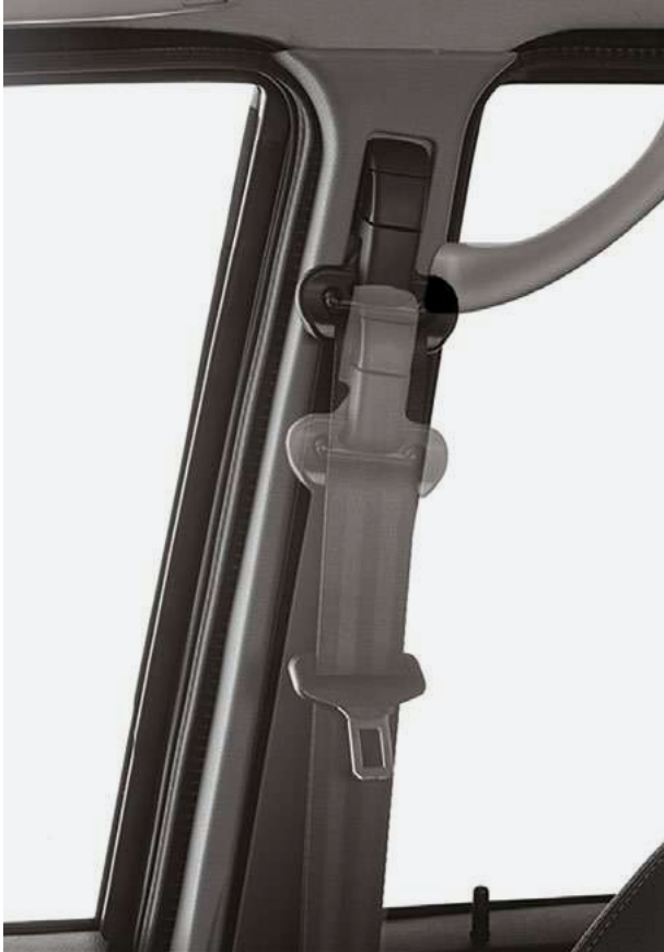
Ремни безопасности с преднатяжителями, ограничителями усилия и регуляторами высоты
