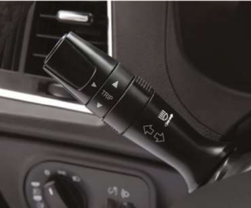
Левый подрулевой переключатель с трассовым режимом поворотников и управлением бортовым компьютером
