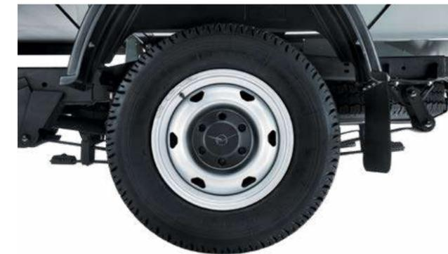
На новый УАЗ Профи устанавливаются новые колесные диски с 6 точками крепления и специальные усиленные шины для коммерческого транспорта. Каждая покрышка выдерживает нагрузку в 1450 кг благодаря увеличенному профилю и повышенной норме слойности для грузовых автомобилей.
