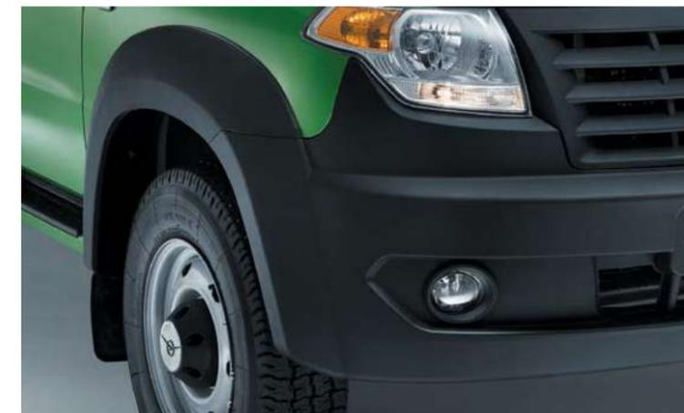
Неокрашенные арки колес и передний бампер
