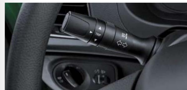
Современные подрулевые переключатели и блок управления светом
