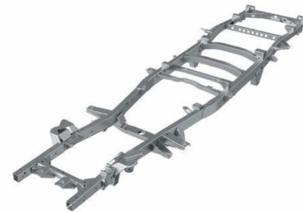
Благодаря прочной рамной конструкции новый УАЗ Профи прекрасно адаптирован под российские условия эксплуатации и предусматривает возможность установки широкой гаммы надстроек.
