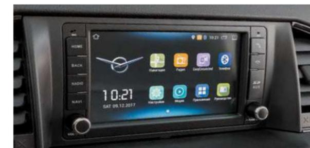
Мультимедийный сенсорный 7-дюймовый дисплей с оптимизированным углом наклона и удобным расположением на приборной панели (опция).
